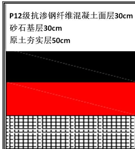
图 10-2 淋溶水收集沉淀池、尾矿填充站事故池地面防渗结构示意图
